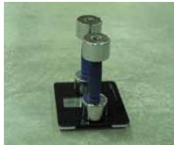
測定前の校正の様子。 1 つ 3Kg の鉄アレイ 2 つを載せて構成します。
